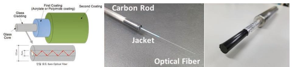
긴장재용 탄소섬유 케이블 제작에 사용되는 FBG(Fiber Bragg Grating) 센서는 국부적인 부분의 변형률을 계측할 수 있는 센서로서 베어(Bare) 상태의 광케이블을 이용하며, 원하는 위치를 지정하여 자외선에 노출시키는 방법으로 제작하였고 또한 정확성과 1kHz 이상의 고속측정이 가능하기 때문에 동적계측에도 활용될 수 있는 장점이 있다.
